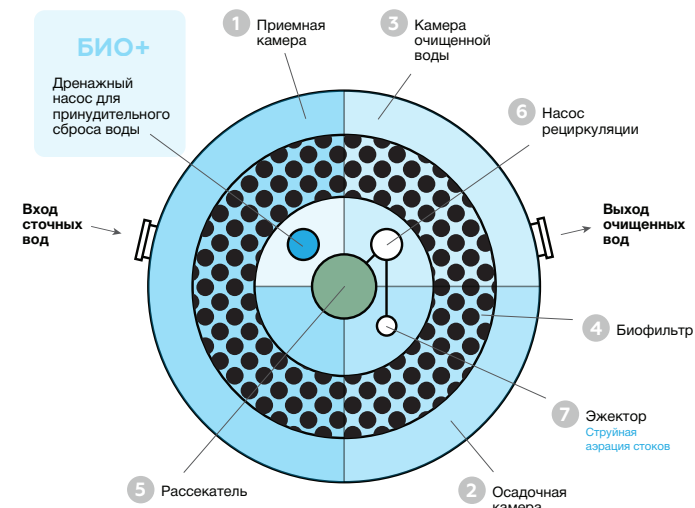
Технологическая схема биологической очистки сточных вод.
